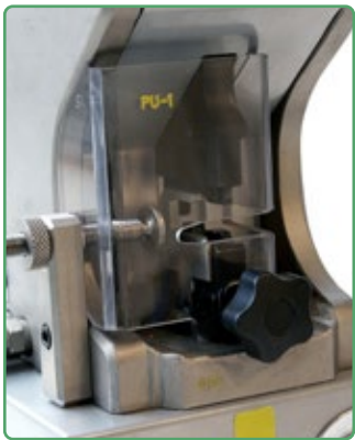
PU-1 muhafazalı sıkma bölgesinin PNB-1 detayı.
